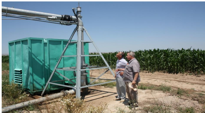
Орошение кукурузы дождевальной машиной кругового действия радиусом 510 м модели T-L с центральным приводом в Жамбылской области
