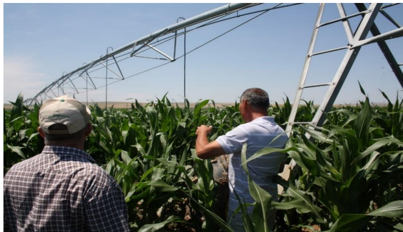
Орошение кукурузы дождевальной машиной кругового действия радиусом 510 м модели T-L с центральным приводом в Жамбылской области
